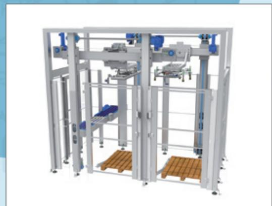
Saugerplatte für Gebindereihen bei kleineren Leistungen
