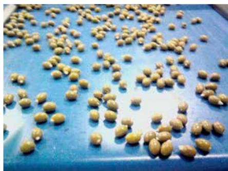
Speziell für sensible Produkte konzipierter Längsfüller - auf Grundlage des über viele Jahre bewährten **NIKO** HLF Längsfüllers Typ 018 mit Vibrationsförderrinnen und Vibrationsfördertisch.
