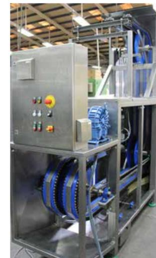
Diese Maschinentypen wurden speziell für kleinere Gebinde wie Glas und Dosen sowie auch Kunststoffgebände (PE / PET) konzipiert. Es besteht die Möglichkeit, die Gebinde abwärts zu fördern und auf Arbeitshöhe wieder abzugeben oder Ein- und Auslaufhöhe gleich zu halten.
