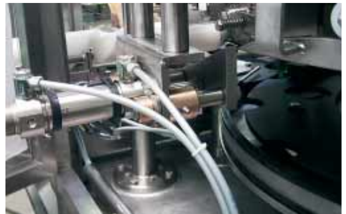
Steuerkurve: Kein Gebinde – keine Füllung
